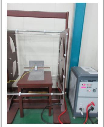
工频磁场试验
