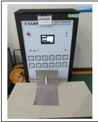
电压暂降、中断抗扰度试验
