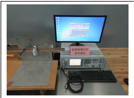
射频传导抗扰度试验
